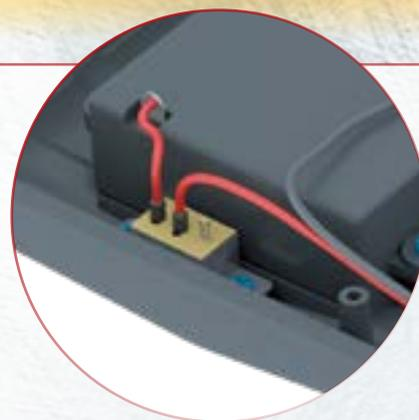
**44.3** **УСТАНОВИТЕ** подготовленный батарейный отсек 44А с внутренней стороны детали 43А так, как показано на фотографии. Удостоверьтесь, что переключатель правильно вошел в предназначенное для него небольшое прямоугольное отверстие в детали 43А. Закрепите батарейный отсек четырьмя винтами FP. ◀
