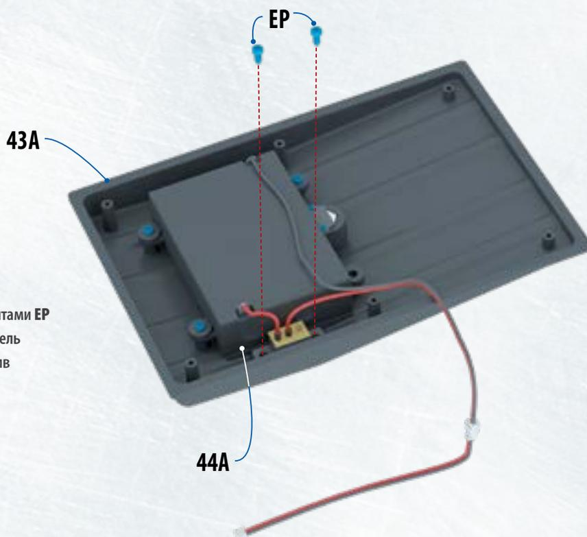
**44.4** **ЗАКРЕПИТЕ** двумя винтами EP на детали 43А переключатель батарейного отсека, вставив их в указанные на фотографии отверстия. ▶
